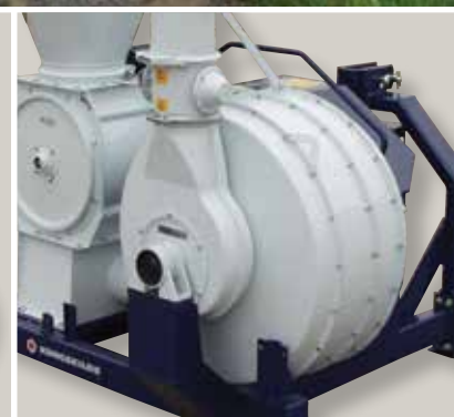
El control automático del aire es estándar en las turbinas accionadas por tractor.
